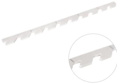
Die separaten Inhaker Haken werden im rechten Winkel auf die Rückseite der Platte geklebt damit man sie in den Inhaker einhängen kann. Die Hakenleiste besteht aus 5 Haken-Elementen. Nach jedem Haken-Element, alle 15 cm, befindet sich eine Kerbe, so dass die Hakenleiste einfach auf die richtige Länge angepasst werden kann.
