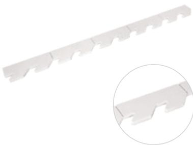
Die separaten Inhaker Seitenhaken werden mit Kleber oder Klebeband auf eine oder zwei Seiten einer Platte geklebt (je nach Dicke der Platte) und dann in den Inhaker eingehängt. Die Seitenhakenleiste besteht aus 5 Haken-Elementen. Nach jedem Haken-Element, alle 15 cm, befindet sich eine Kerbe, so dass die Hakenleiste einfach auf die richtige Länge angepasst werden kann.
